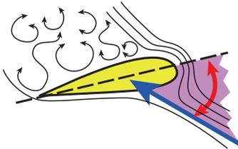
L'angle d'incidence trop fermé (négatif), l'aile se replie.
